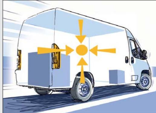
● Il sistema è integrato nell'ESP e ha la funzione di identificare le condizioni di carico del veicolo durante la marcia, in particolare la massa totale e la posizione del baricentro. Al variare di questi parametri, interviene calcolando e comunicando nuove tarature e nuove soglie di intervento alle funzioni ABS, ASR ed ESP, che possono così funzionare sempre con la massima efficienza.
