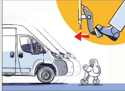
● Incrementa automaticamente la pressione del circuito frenante durante una frenata d'emergenza, consentendo la riduzione degli spazi d'arresto, agendo direttamente sul servofreno. Se il veicolo è dotato di ESP, analoga funzione è svolta dall'HBA (Hydraulic Brake Assistance).
