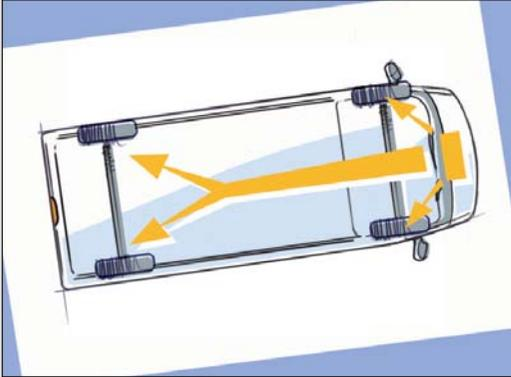
● Il sistema elettronico ripartisce la frenata tra asse anteriore e posteriore, per ottimizzarne l'efficienza in ogni situazione di guida.
